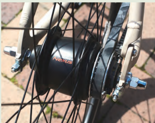
さびにくい内装ハブを搭載した自転車を選ぶことも一つの方法。
